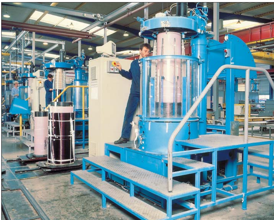
Намотка обмотки высокого напряжения
