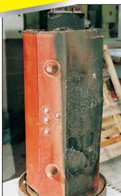
Катушка трансформатора Trihal после испытания F1
